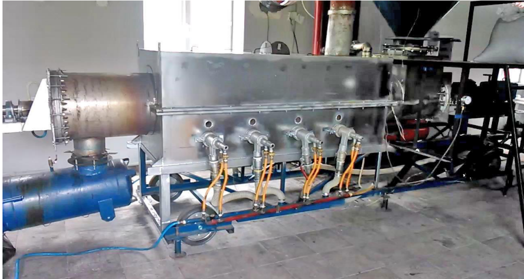
სურათი 3. ინსტიტუტში შექმნილი ნახშირბადოვანი მასალის მისაღები ნახევრად საწარმოო რეაქტორი
